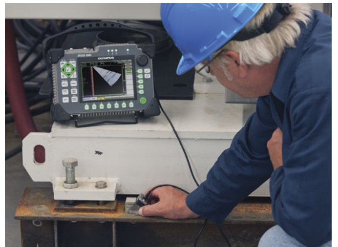
45°聚焦法则的AWS“D”值焊缝定级显示
