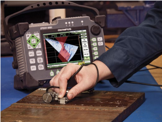
带有焊缝覆盖的相控阵S扫描
